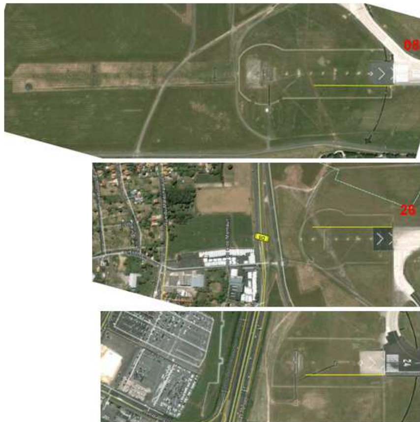
Comparaison équipements de pistes : 08 (à déplacer) versus 26 et 24 Altitude prise de vue GE : 1,19 km Image GE : 12/06/2005 Chaque barre jaune fait 200 m de long sur le terrain
